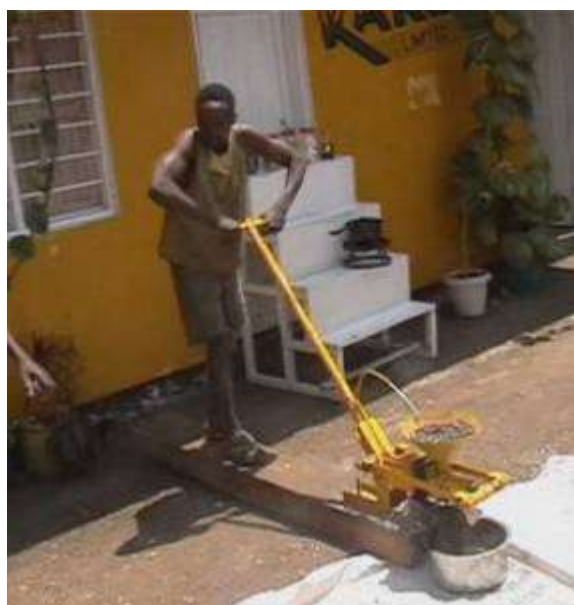
Figura 2 – La prensa RAM Bielenberg operada en Kakute Ltd., Tanzania [12]
