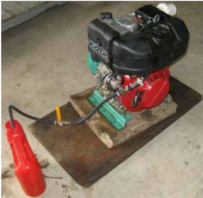
Figura 5.11 Bomba de riego Lombardini 15 LD 440, (1 cilindro 442ccm, 10.5 HP) con motor de inyección directa refrigerado con arranque manual. Convertido a un sistema sencillo de 2 tanques. Honduras, Octubre de 2008 (Proyecto Gota Verde).
