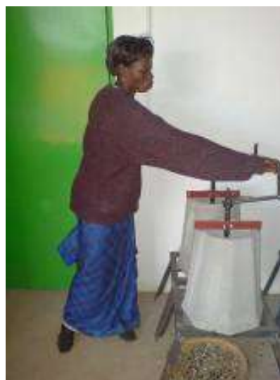
Figura 2: UNS en uso - Universal Nut Sheller [1]
