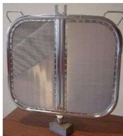
Figure 17 Acercamiento a una de las placas o láminas del filtro. El marco alrededor de la malla está hecho de tubería perforada que sirve para la descarga del aceite limpio [Fotografía: amafiltergroup].
