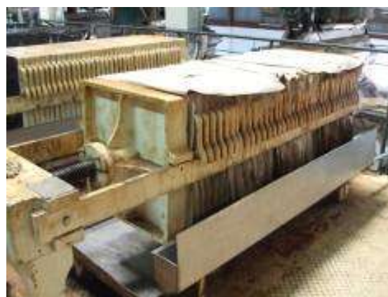
Figure 15 Filtro de placa utilizado en la industria alimenticia, con una capacidad de alrededor de 1,000 litros/hora.
