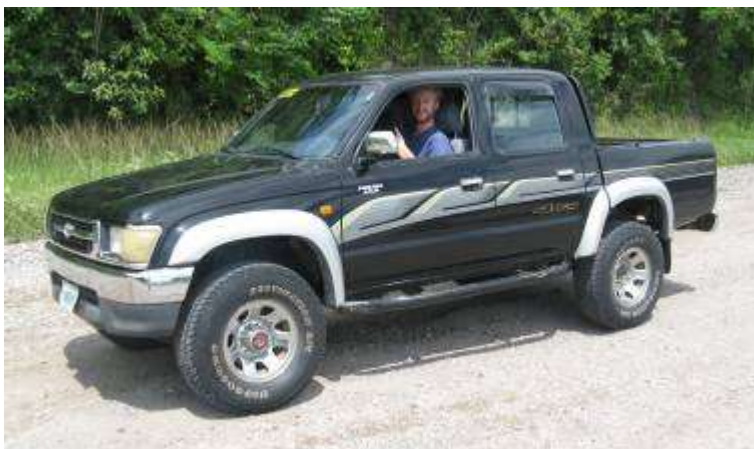
Figura 5.12 Toyota Hilux 2.8 D (3L). Motor de inyección indirecta. Convertido por un sistema de tanque único Elsbett. Honduras, Octubre de 2008 (Proyecto Gota Verde).
