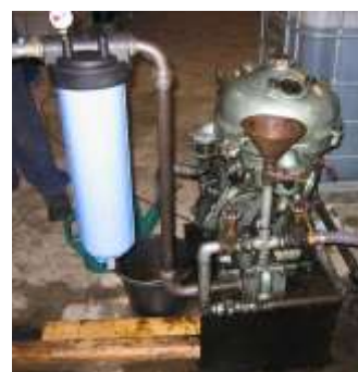
Figura 24 - Ejemplo de un sistema de centrifugación con un filtro de bolsa como seguridad [12].
