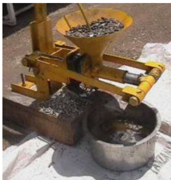
Figure 3 – Detalle del mecanismo Bielenberg de prensado. Nótese la descarga automática de la cámara de prensado y el obturador en el embudo de semillas [12]
