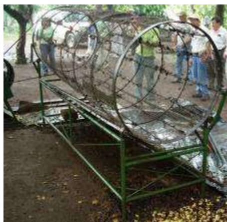
Figura 6: Esquema y fotografía de un separador en operación (usado en el Proyecto Gota Verde en Honduras)
