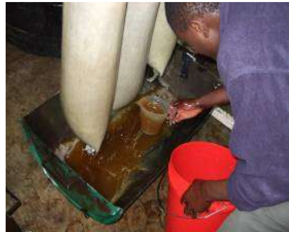
Figura 11 – Extremo superior izquierdo: filtración de aceite de cocina usado en el sitio del proveedor alemán Monopool. Extremo superior derecha: instalación de filtración simple con bolsas filtro [Fotografía: Diligent Tanzania Ltd.]. Extremo inferior izquierdo: instalación mejorada de bolsas filtro [Fotografía: Diligent Tanzania Ltd.]. Extremo inferior derecha: Un empleado recoge una muestra de aceite para su análisis después de la filtración [Fotografía: Diligente Tanzania Ltd.]
