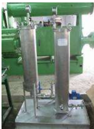
Figura 20 Instalación combinada de un filtro tipo bolsa y vela de amafiltergroup [Fotografía: Diligent Tanzania ltd.].
