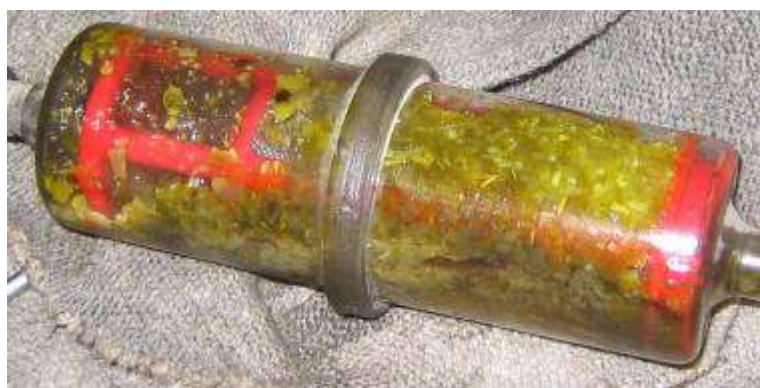
Figura 5.8 La fotografía muestra un pre-filtro en línea parcialmente bloqueado por pequeñas partículas de grasa sólida, liberado de una pequeña pieza de acero recubierto por zinc en el tanque del aceite vegetal puro.
