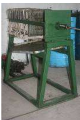
Figure 14 Filtro de placa con capacidad de 150 litros/hora en Diligent Tanzania Ltd., producido por TEMDO Tanzania.
