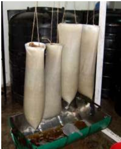
Figura 11 – Extremo superior izquierdo: filtración de aceite de cocina usado en el sitio del proveedor alemán Monopool. Extremo superior derecha: instalación de filtración simple con bolsas filtro [Fotografía: Diligent Tanzania Ltd.]. Extremo inferior izquierdo: instalación mejorada de bolsas filtro [Fotografía: Diligent Tanzania Ltd.]. Extremo inferior derecha: Un empleado recoge una muestra de aceite para su análisis después de la filtración [Fotografía: Diligente Tanzania Ltd.]
