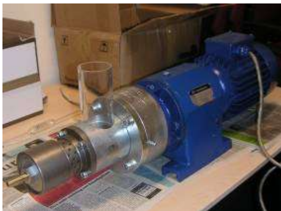
Figura 6 - La prensa BT danesa es un ejemplo de una prensa de tipo cilindro agujereado. En el extremo izquierdo puede observarse la boquilla [10].
