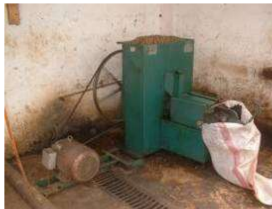
Figura 7 - La prensa de aceite Sundhara es una muestra de las prensas de tipo filtro. En el lado derecho puede observarse el mecanismo que regula la presión (“choke”). [12]
