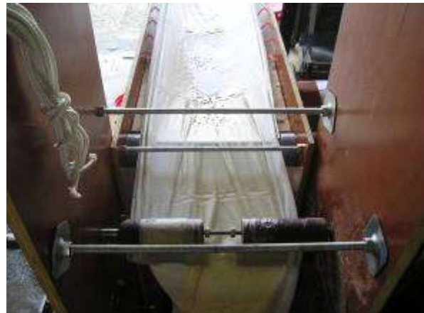
Figura 13 - Filtro de banda en funcionamiento. Los rodillos de transporte están equipados con papel de lija para mejorar la fricción. La tela se está moviendo continuamente.
