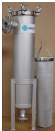
Figura 19 filtro bolsa contenido en cestas de filtrado de www.amafilter.nl . La bolsa del filtro se inserta dentro de la cesta y necesita limpiarse cada 14 días.
