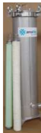
Figura 21 Armazón del filtro de velas con sus velas de www.amafilter.nl . Las velas deben ser sustituidas cada 6-8 semanas.
