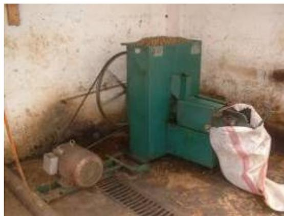
**Figura 7** - A prensa de óleo de Sundhara é um representante das prensas tipo peneira. No lado direito o ajuste do aperto. [12]
