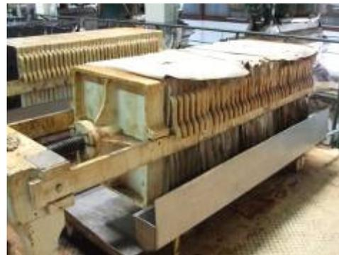
**Figura 15** Placa de filtro para a indústria alimentar, a capacidade de cerca de 1000 litros / hora.
