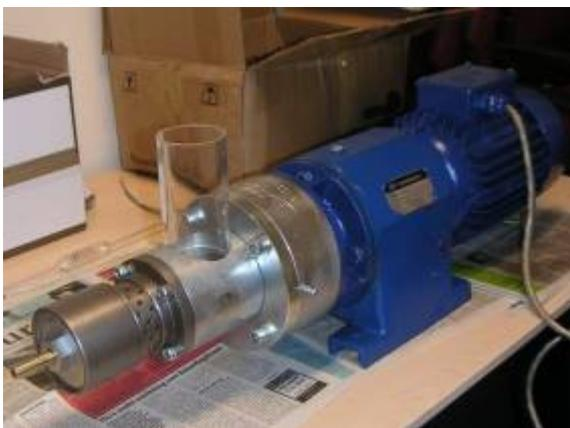
**Figura 6** - A prensa dinamarquês BT é um exemplo de prensa de tipo buraco cilíndrico. Observe o bico, à esquerda na frente [10].
