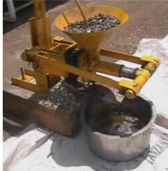
**Figura 3** – Vista aproximada da Bielenberg mecanismo de prensagem. Aviso de descarga automática da câmara de pressão e a rola na semente funil [12]
