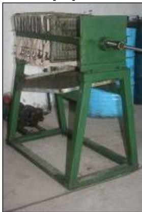
**Figura 14** Filtro de Placa com capacidade de 150 litros / hora. Na Tanzânia Diligent Ltda. Produzido por TEMDO Tanzânia.
