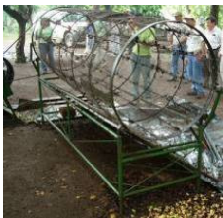
Figura 6: Desenho e fotografia de um separador em funcionamento (usado no Projeto Gota Verde em Honduras)
